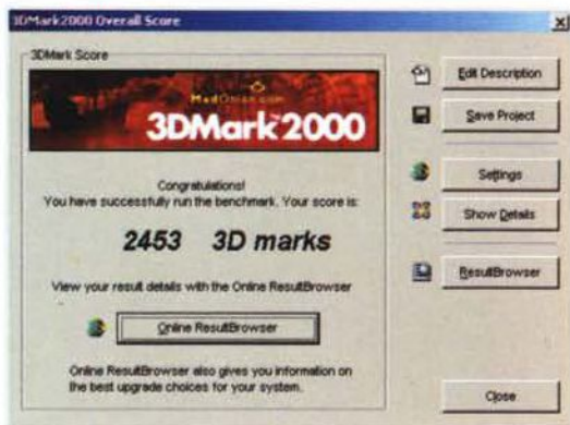
Il test 3Dmark2000 riporta il discreto valore di 2453 3Dmarks, risultato che potrebbe essere comunque espresso per difetto.
